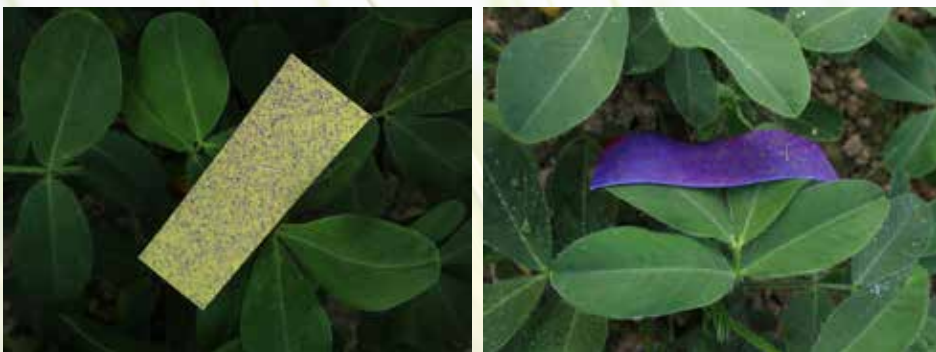
Ảnh 6. phun đều, phù hợp (trái) phun quá nhiều nước (phải)
